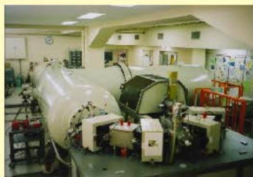
加速器質量分析法 AMS (Accelerator Mass Spectrometry)
