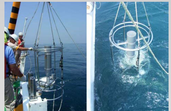
係留機器の投入の様子
